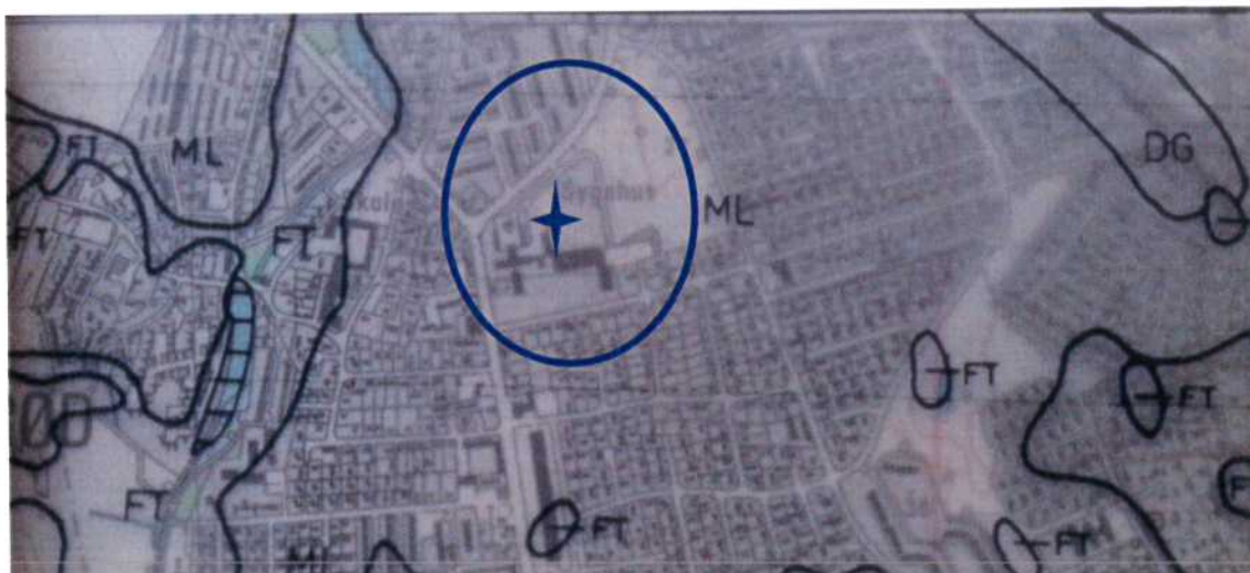
Figur 2: Geologisk jordartskort 1514 II SØ Holte over området med PH Park (blå cirkel). Det ses at den overfladenære geologi i PH Park består af moræneler (ML). Den blå stjerne angiver placeringen af boring DGU nr. 194.363. ML: moræneler, FT: Ferskvandstørv. DG: smeltevandssand.
